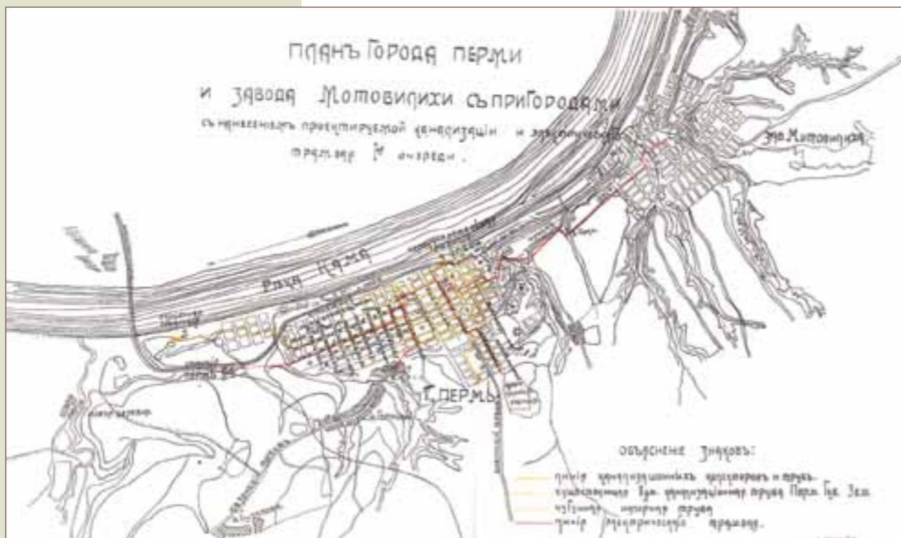
План города Перми и завода Мотовилихи с нанесением проектируемой канализации и линиями трамвая первой очереди
