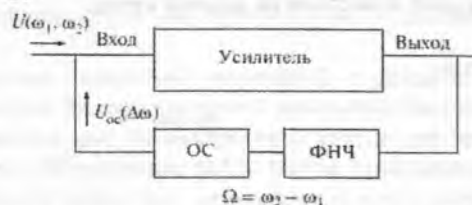
Рис.1. Блок-схема усилителя с низкочастотной обратной связью для понижения уровня ИМН.
