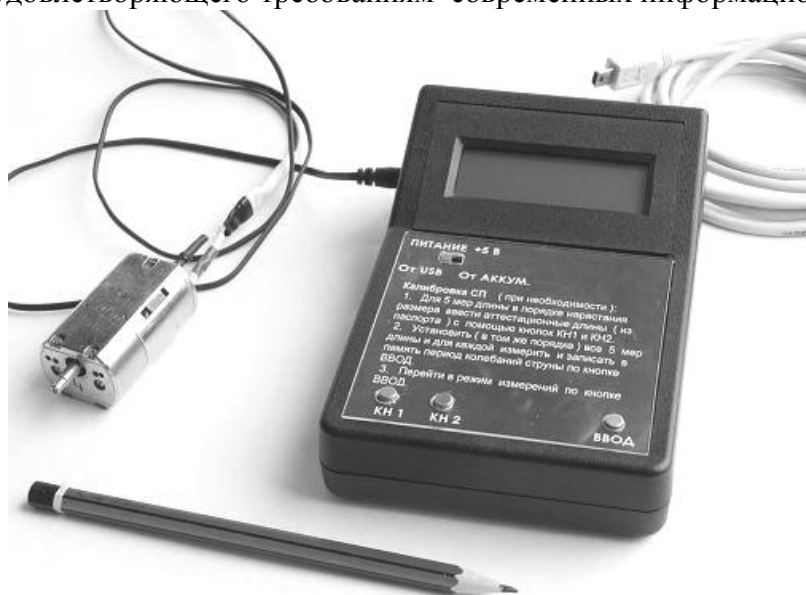
Рис.1 Частотно-цифровое средство измерений со струнным преобразователем
