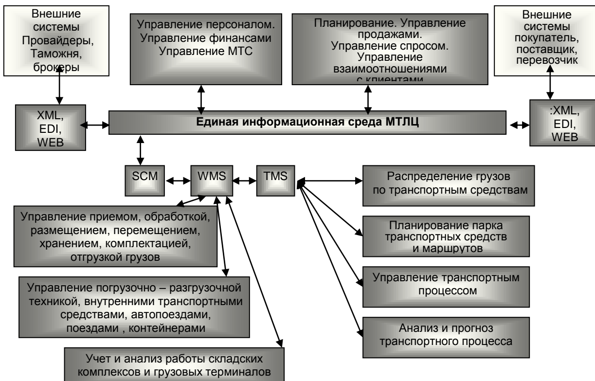
Рис. 1. Общая архитектура корпоративной системы управления
