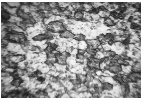
Рис. 1. Конструкционная сталь типа Ст3 (микроструктура: темные зерна -перлит, светлые –феррит) (увеличение x400)
