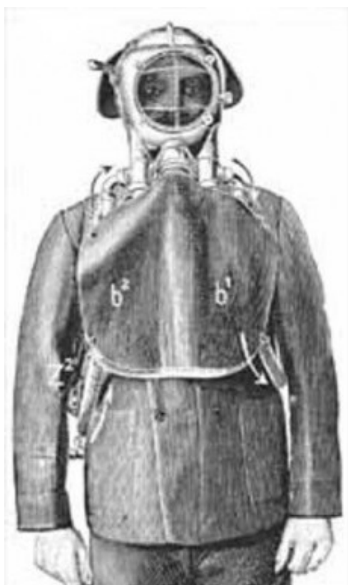
Рис.1 Дыхательный аппарат для пожарных немецкой фирмы Драгер, 1903 год
