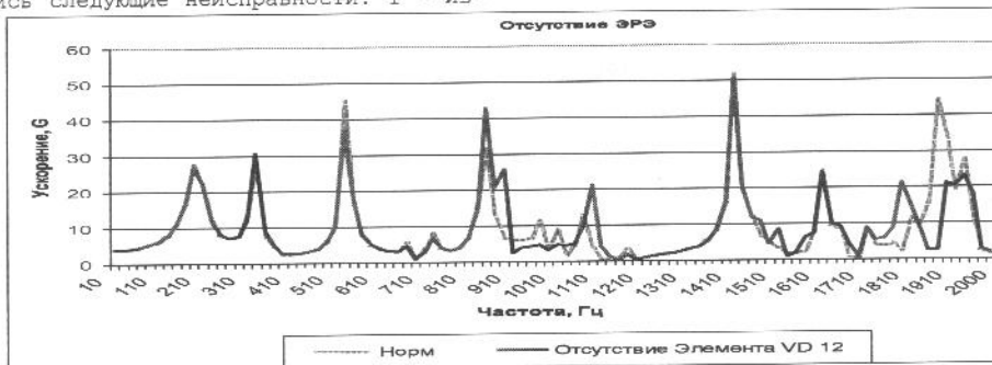
Рис. 17. Амплитудно-частотные характеристики ПУ при отсутствии ЭРЭ VD 12
