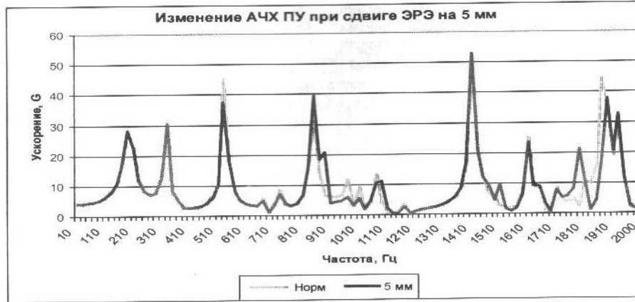
Рис. 21. АЧХ ПУ БУАП при сдвиге ЭРЭ VD-12 на расстояние 5 мм.
