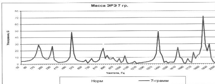
Рис. 19. Амплитудно-частотные характеристики ПУ при массе ЭРЭ VD 12 7гр
