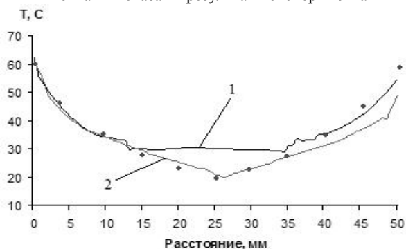
Рис. 7. Характеристики распределения температуры по поперечному сечению стержня для замедляющей системы типа диафрагмированного волновода в стационарном режиме в сечении z = 0 , полученные в Ansoft HFSS (1) и CST Microwave Office (2), точками показаны результаты эксперимента
