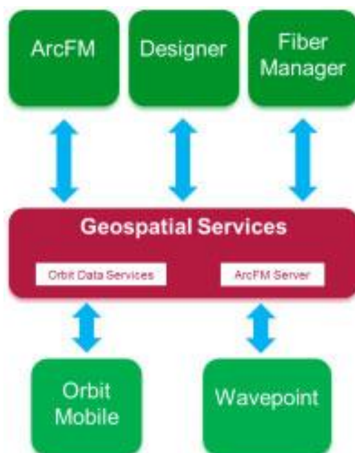
Рисунок 3.20 Пять основных модулей системы Orbit, взаимодействующих с корпоративным геопространственным сервисом через ArcFM сервер системы.
