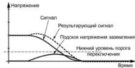
Рис. 4. Эффект подскока напряжения заземления на функционирование цифрового узла
