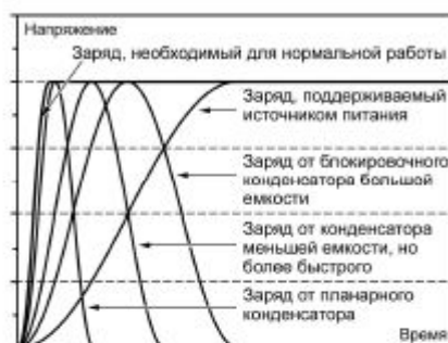
Рис. 6. Иллюстрация влияния различных типов развязывающих конденсаторов при переключении вентили
