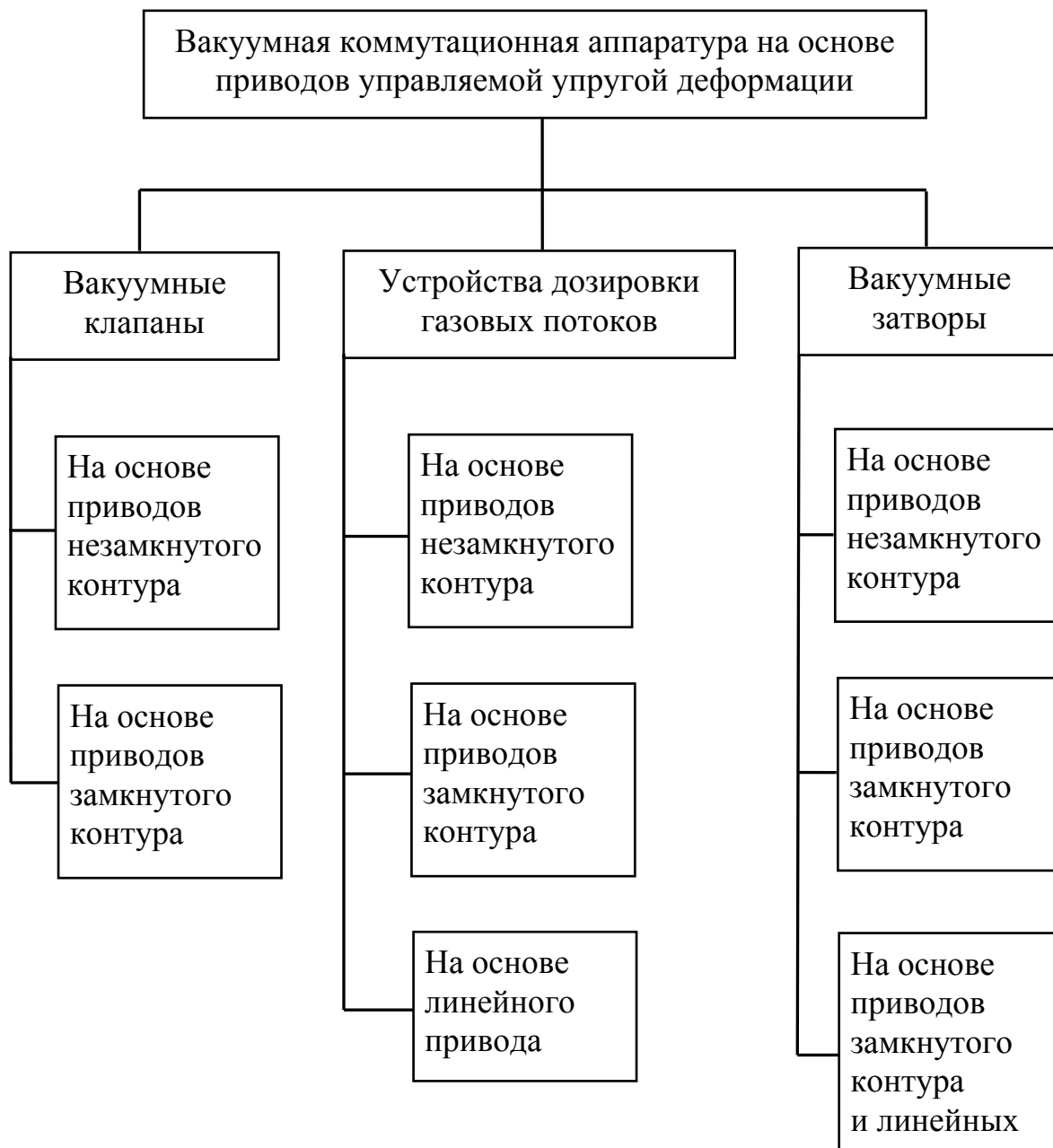
Рис. 4.1. Классификация вакуумной коммутационной аппаратуры на основе приводов управляемой упругой деформации
