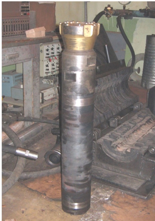
Рис. 2. Пневмоударник с импортной коронкой SPEED Ø165 мм
