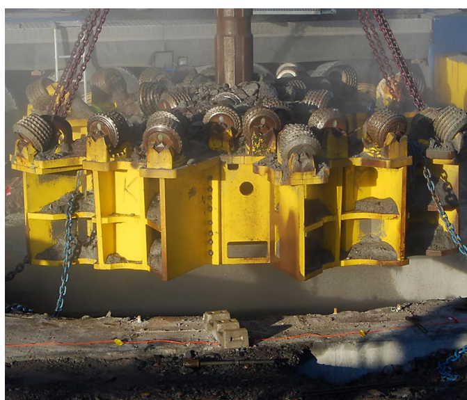
Рис. 3. Расширитель, производимый компанией Atlas Copco
