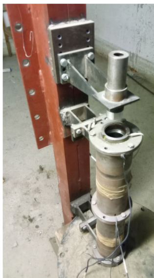
Рис. 4. Стенд с моделью электромагнитного молота
