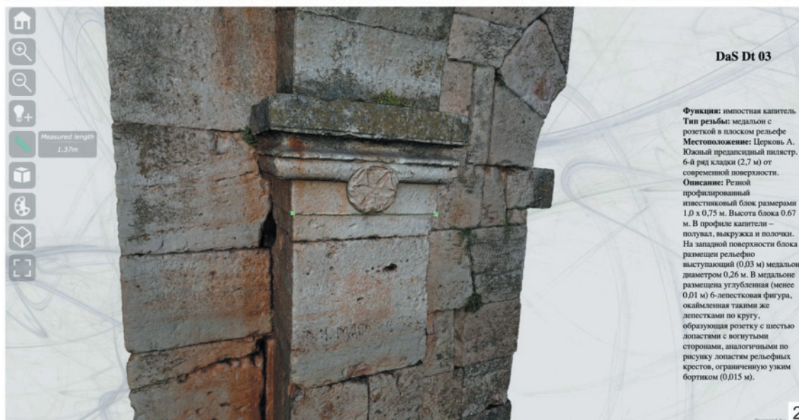
Рис. 4. Примеры визуализации: 1 — трехмерной модели в виде облака точек в среде potree в браузере; 2 — полигональной трехмерной модели в среде 3DHOP
