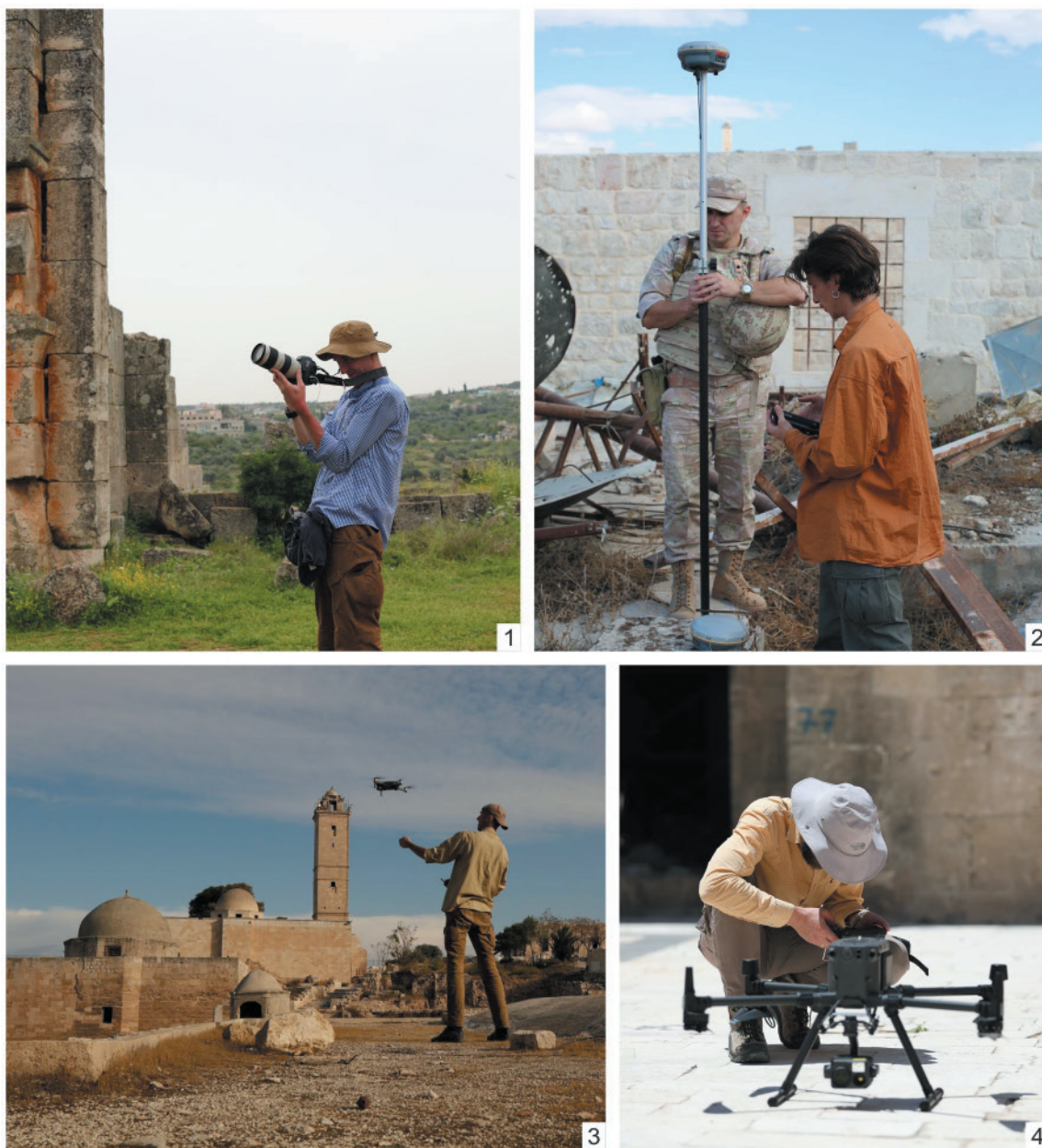
Рис. 2. Съёмка памятников Сирии сотрудниками ИИМК РАН: 1 — Ю. В. Румянцев проводит съёмку храма А в Дейр эс-Салиб; 2 — М. М. Городилов ведёт геодезические работы в Медресе Халавие, Алеппо; 3 — Ю. В. Румянцев проводит аэрофотосъёмку в цитадели Алеппо; 4 — Е. К. Блохин готовит квадрокоптер Matrice 300 к работе на церкви Св. Георгия в Эзре
