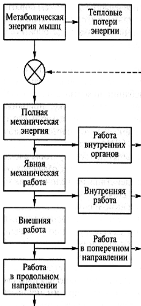
Рисунок 2 – Этапы преобразования энергии при двигательной деятельности человека (по Зациорскому В.М., Алешинскому С.Ю., Якунину Н.А.) → - расходуемая энергия, — →поток рекуперированной энергии, X- суммирование потоков энергии.
