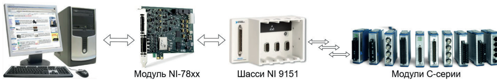
Рис. 6-5б. Внешний вид компонентов системы на основе многофункционального модуля R-серии с шасси расширения и модулями C-серии
