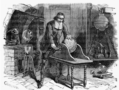
Рис. 2. Первый электростатический генератор, изобретенный немецким физиком Отто фон Герике. Гравюра по дереву. Франция. XIX век
