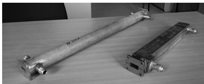
Рисунок 5. Образцы волноводных нагрузок с поглотителем, нанесенным на нержавеющую сталь и медь
