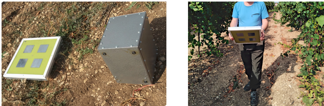
Рис. 1. Внешний вид СВЧ-радиометров L-диапазона, С-диапазона (слева) и способ транспортировки (справа)
