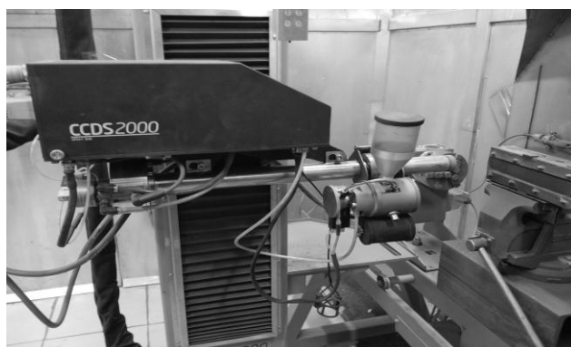
Рисунок 4. Установки детонационного напыления CCDS-2000
