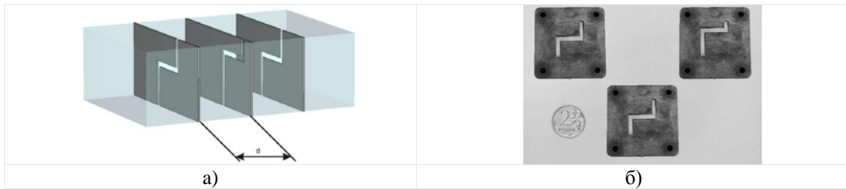
Рис. 1. Модель синтезированного фильтра: а) 3D-модель фильтра; б) изготовленные диафрагмы
