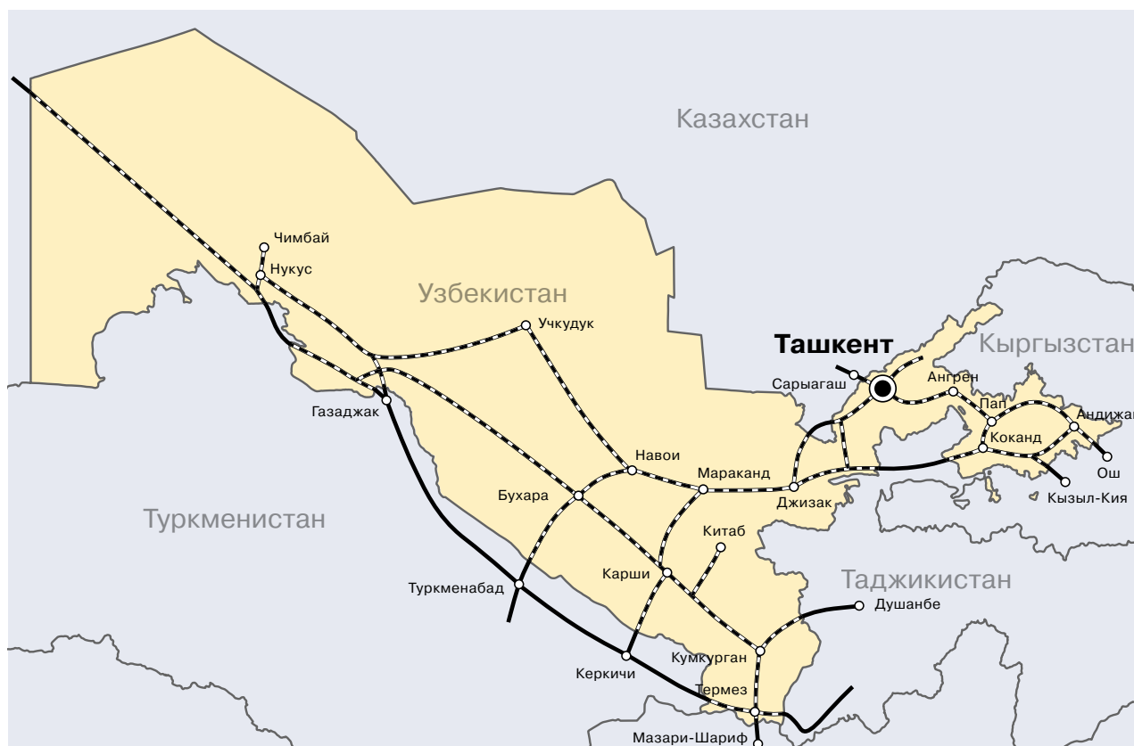
Рисунок 43. Схема сети железных дорог Узбекистана
