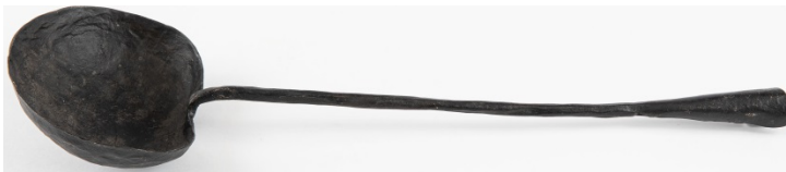
Рис. 3. Ложка – старательский инструмент для отжигания золота от ртути. Г. Енисейск. 1904 г. Собираетель А.А. Макаренко. РЭМ 563-46
