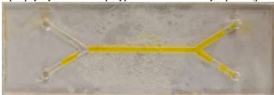
Рис. 4. Микрофлюидная система, сформированная с помощью низкотемпературного метода
