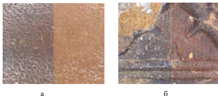
Рис. 3. Изображения с оптического микроскопа корешка старинной книги после лазерной очистки: (а) – области без тиснения; (б) – область с тиснением
