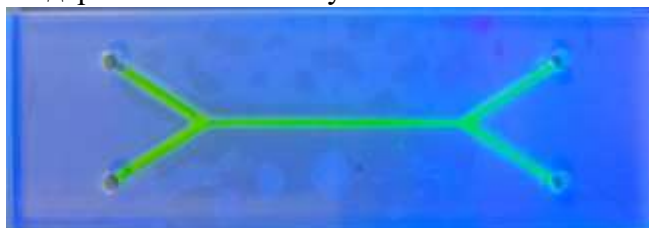
Рис. 2. Микрофлюидная система, сформированная с помощью ступенчатого нагрева
