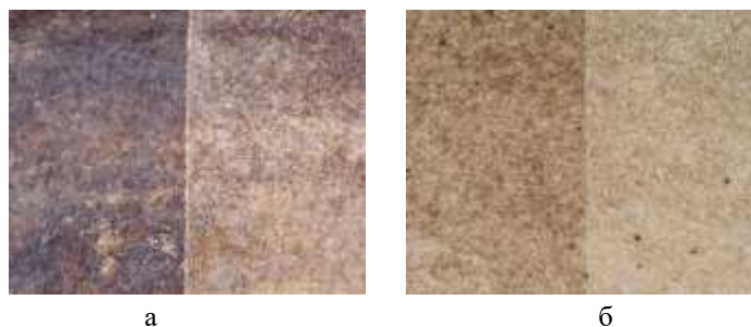
Рис. 5. Изображение с оптического микроскопа фрагмента исторического пергамента после лазерной очистки: (а) – область сильного загрязнения; (б) – область слабого загрязнения (справа не очищенная область, слева - после лазерной очистки)
