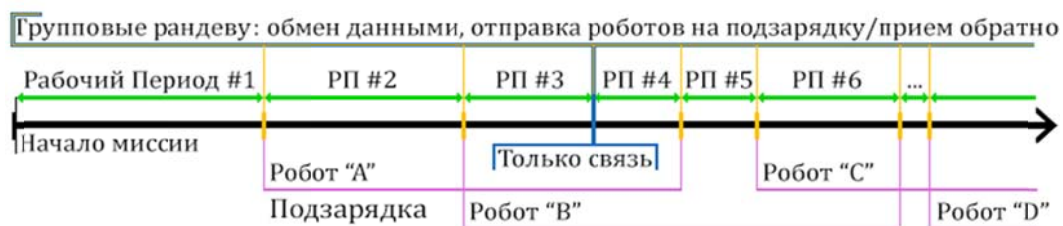
Рис. 1. Декомпозиция миссии на последовательность рабочих периодов
