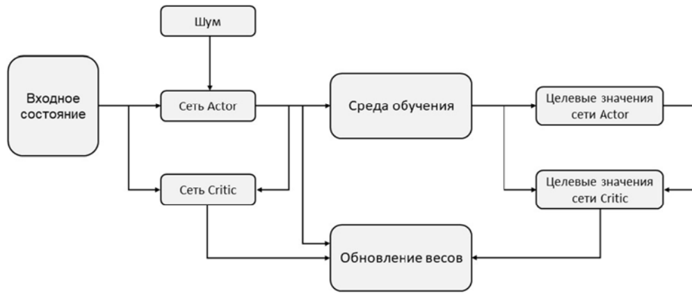
Рис. 1. Структурная схема DDPG алгоритма
