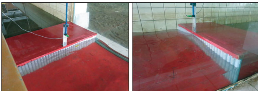
Рис. 7. Отсутствие волнового заплеска на верхнее строение причала, отметка кордона причальной набережной +4,500 м
