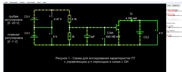
Рисунок 2 – Схема для исследования характеристик полевых транзисторов
