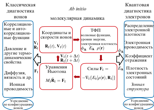
Рис. 3. Общая схема расчёта в рамках квантового метода молекулярной динамики. Расчёт зонной структуры (выделен курсивом) проводится для кристаллической решётки и не усредняется по времени, в отличие от других параметров.
