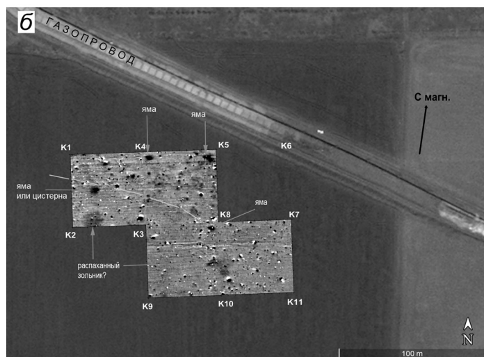
Рис. 1. а - Положение поселений Тобечик 9 и Тобечик 8 на карте масштаба 1:10000 с показанием площади, занятой прецизионной геодезической съемкой. б - Результат интерпретации данных магнитной съемки на поселении Тобечик 8 на фоне космического снимка
