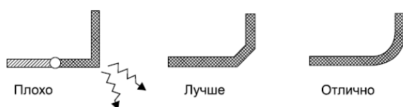
Рис.4. Сглаживание углов проводников
