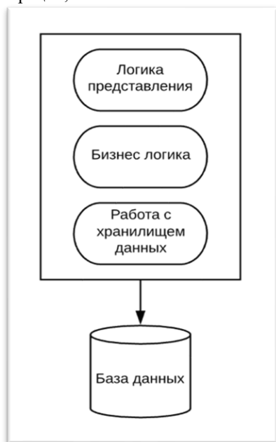
Рис.1. Схематическое представление монолитной архитектуры
