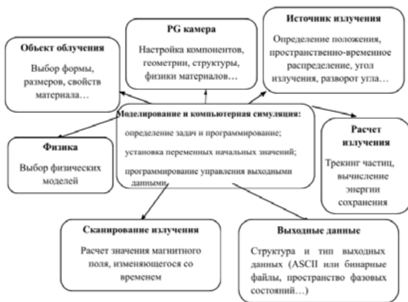
Рис. 2. Фреймворк компьютерной симуляции системы камер 5 (Ibid., p. 981).
