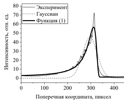
Рис. 1. Исследование профиля интенсивности светового пятна при наклонном падении сфокусированного цилиндрической линзой гауссова пучка: световое пятно на поверхности в виде полосы, полученное экспериментально (а), аппроксимация усредненного распределения интенсивности фокусного пятна гауссианом и функцией (1) (б) (500 пикселов соответствует 1 мм)
