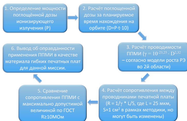
Рис. 3. Критерий и инженерная методика прогнозирования долговечности подложек ГПП при повышенных уровнях радиации
