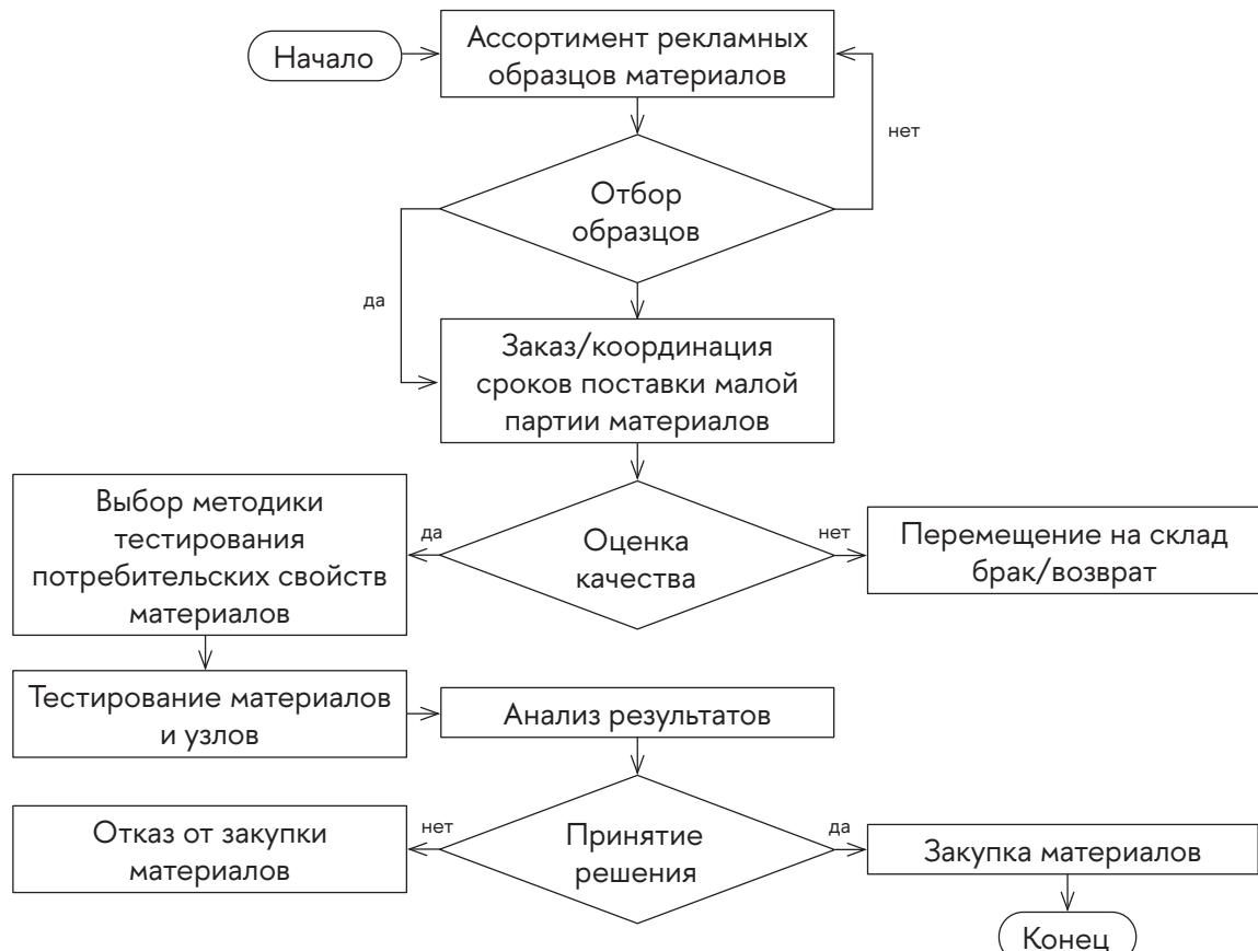
Рисунок 2.1. Алгоритм процесса внедрения нового материала на предприятии при проектировании швейного изделия
