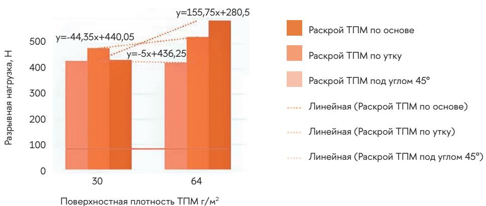
**Рисунок 3.32.** Ткань № 2. Приложение нагрузки под углом 45°
