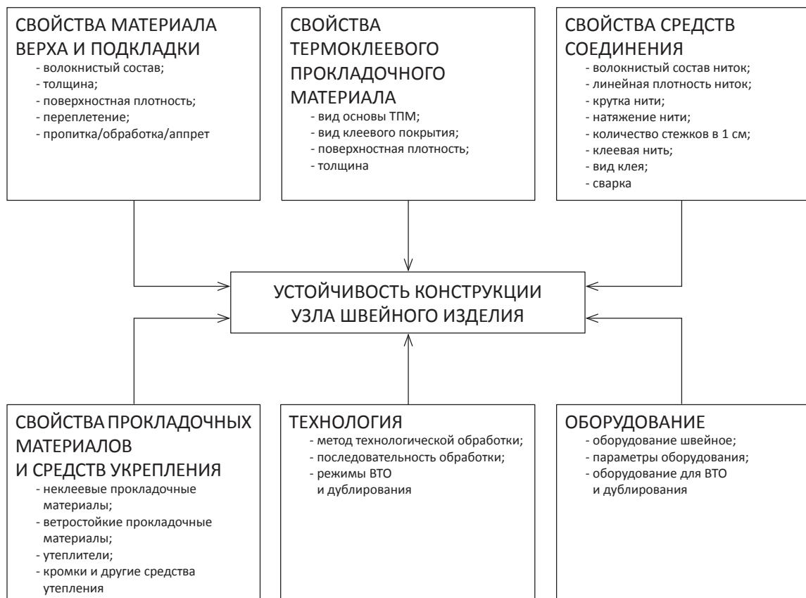
**Рисунок 2.8.** Влияние производственных факторов на устойчивость конструкции узла швейного изделия
