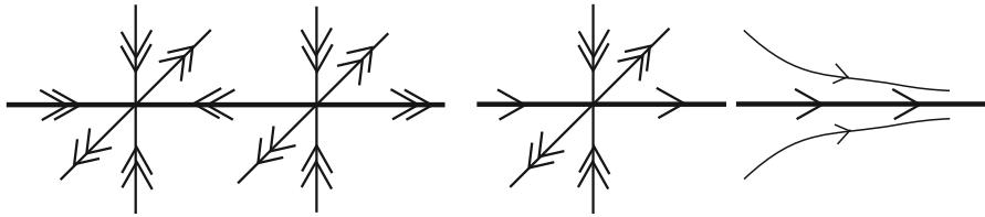
Рис. 2. Седло-узловая бифуркация
