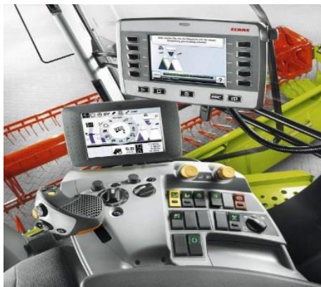
Рис. 1.3.6. Бортовая информационная система CEBIS с интегрированными в нее элементами интеллектуальной системы управления на основе гибридного вычислительного интеллекта
