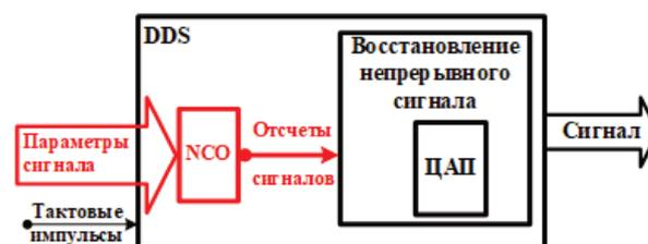
Рис. 2. Структура цифровых формирователей сигналов на основе прямого частотного синтеза
