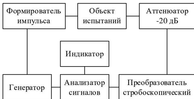
Рис. 11. Схема для измерений во временной области
