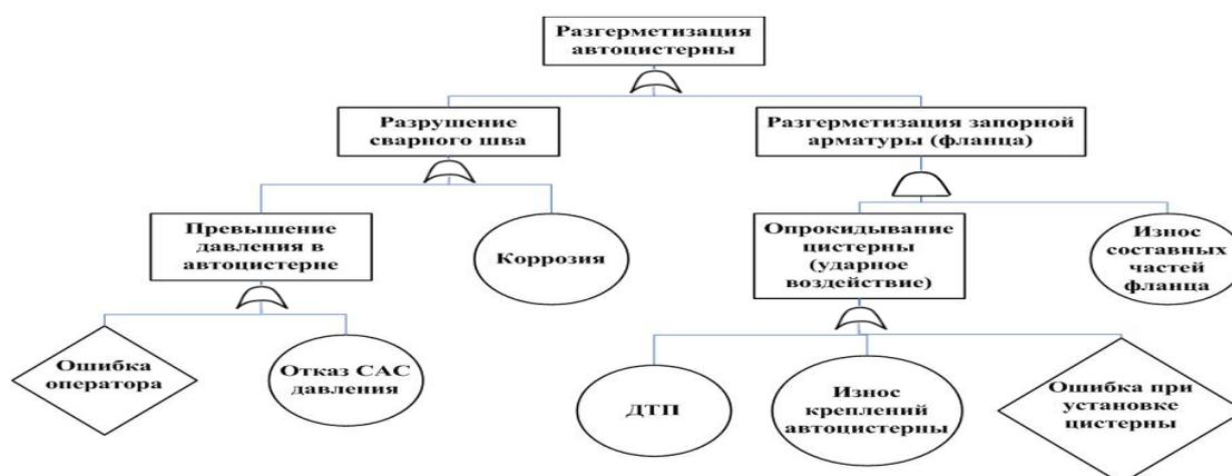
Рис. 1. Анализ причин разгерметизации АЦ.
