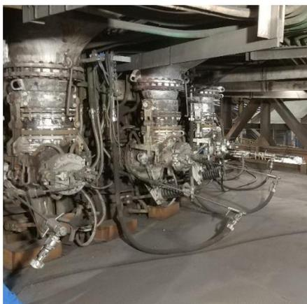
Рис. 1. Фурменный прибор доменной печи №4 ПАО «НЛМК».
