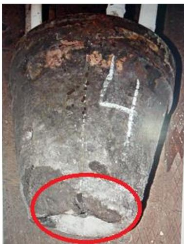
Рис. 3. Пример образования трещины «рыльной» части воздушной фурмы.
