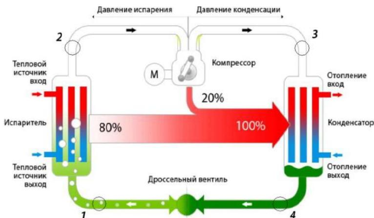
Рис.1. Принцип работы теплового насоса.
