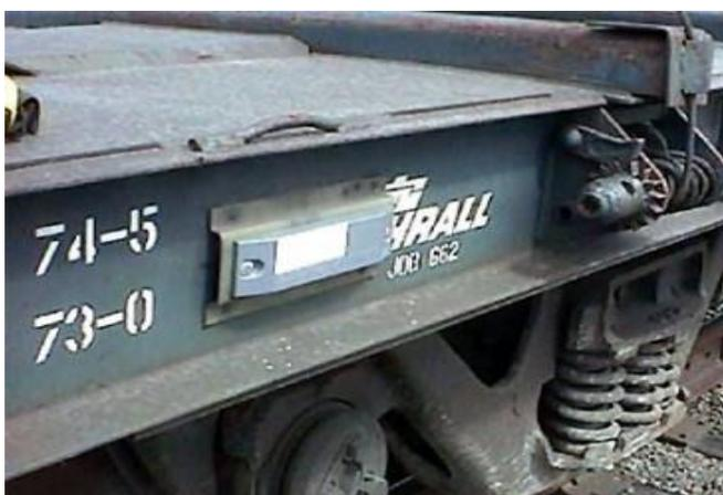
Рис.2. Пример установки RFID метки.
