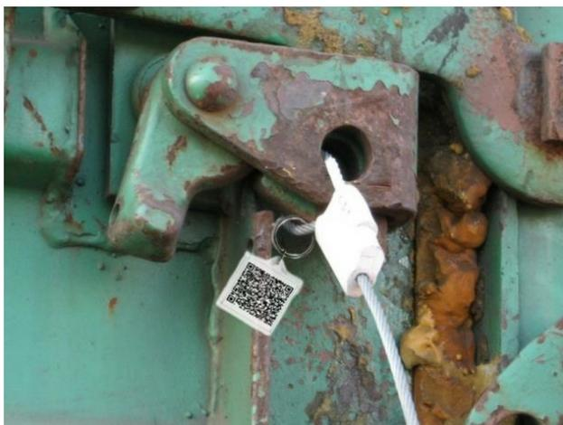
Рис. 1. Пример установки брелка с QR кодом.
