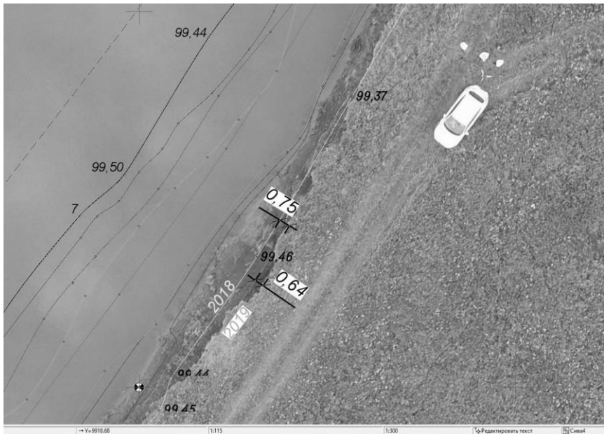
Рис. 2. Выявление неточностей тахеометрической съемки.
