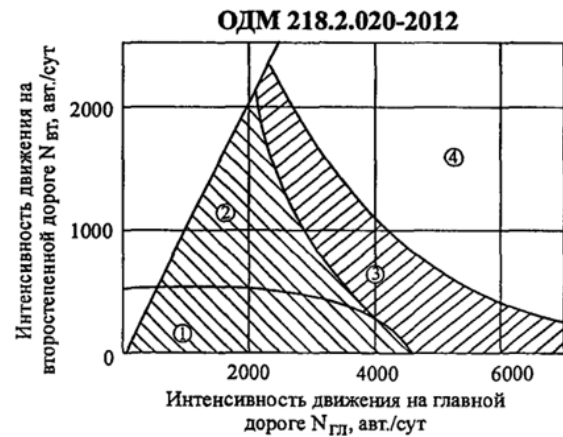
Рисунок 5 – Номограмма для определения пропускной способности пересечения
