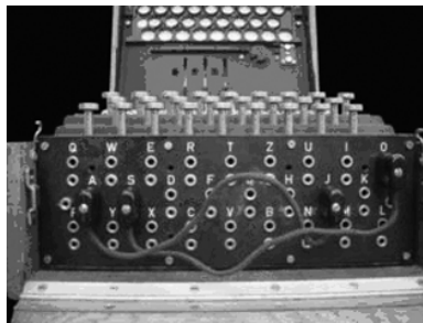
Рис. 1.15. Коммутационная панель «Энигмы»
