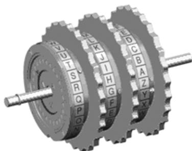
Рис. 1.13. Три последовательно соединенных ротора
