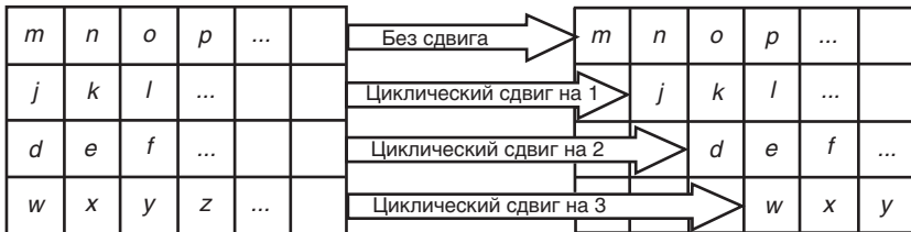
Рис. 1.29. Схема преобразования ShiftRow
