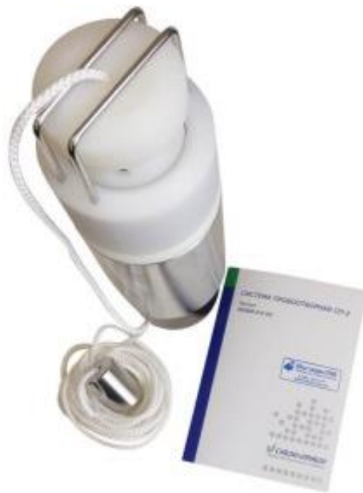
Рис. 2. Приборы для осуществления измерения глубины водоема: эхолот Garmin echo 150 (А) и Система пробоотборная СП-2 (Б)
