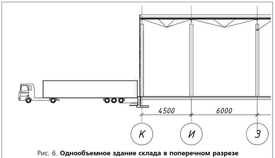
Рис. 6. Однообъемное здание склада в поперечном разрезе
