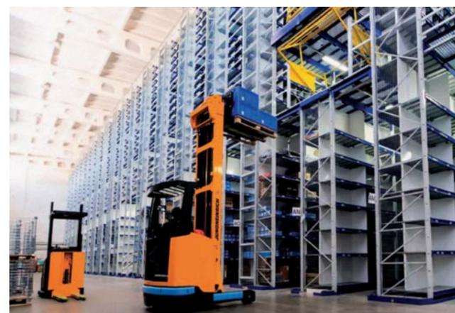
Рис. 3. Складской мезонин на стеллажных конструкциях
