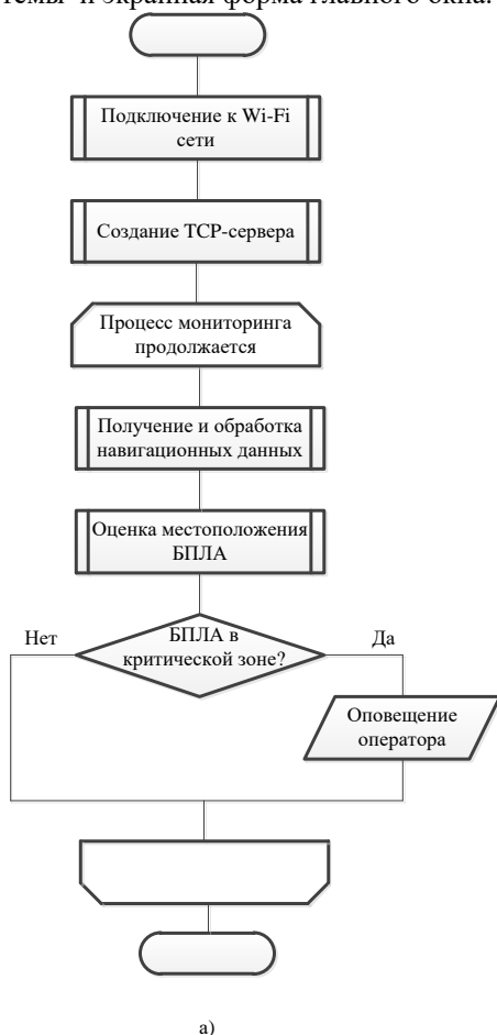
Рисунок 2 – Программа мониторинга отклонения БПЛА: а) – схема алгоритма; б) – экранная форма главного окна
