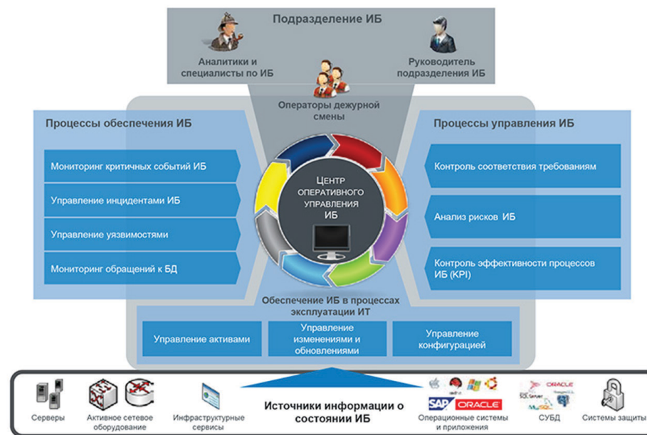
Рис. 2.6. Базовые компоненты SOC
