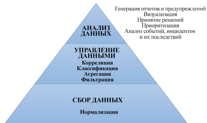
Рис. 2.5. Обобщенная иерархическая модель SIEM-системы
