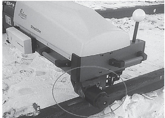
Рис.6. Дополнительное «колесо» для прохода стрелок
