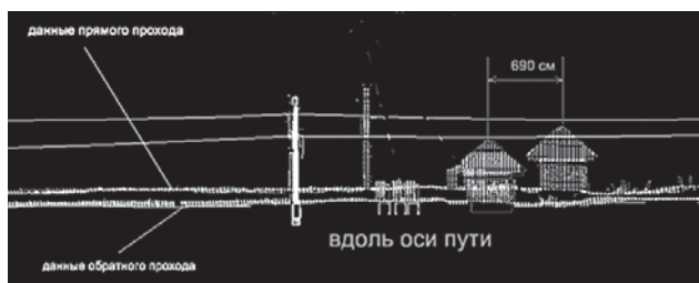
Рис.16. «Сходимость» измерений комплекса «ЭРЫ» при проходе по одному участку пути в направлении «туда» и «обратно»
