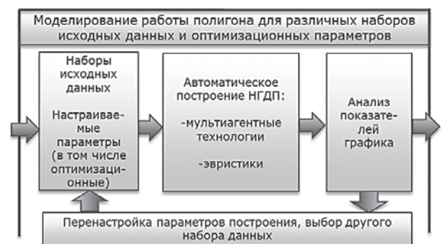
Рис. 2. Новая технология разработки ГДП (с помощью ИСУЖТ)
