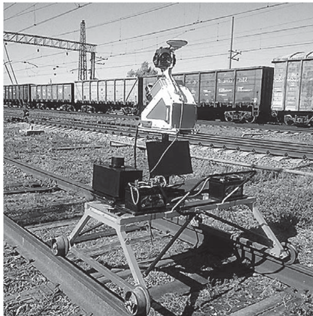
Рис.11. Общий вид тележки с установленным сканирующим комплексом
