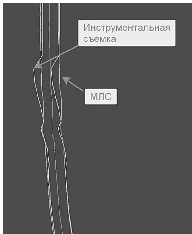
Рис.13. Отклонение измерений, выполненных комплексом АГМ-МС7.2100 и традиционной инструментальной съемкой в плане и по высоте .
