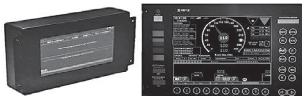
Рис.7. Модуль МПУЛ: дополнительный и основной блоки индикации
