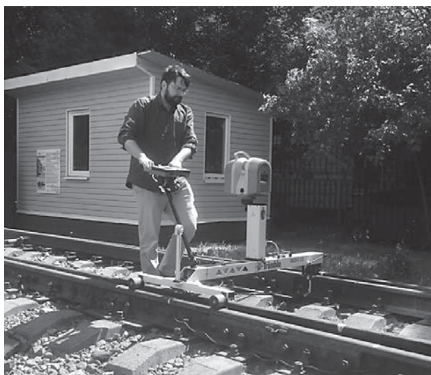
Рис.10. Общий вид тележки с установленным сканирующим комплексом
