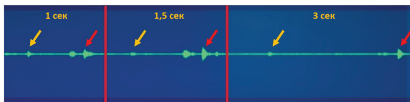
Рис. 6. Прохождение турникета тремя пассажирами: звуки разблокировки и вращения турникета (звуковая дорожка одного прохождения турникета — https://drive.google.com/file/d/1ZD7yRxHXo6eWngUx68IWgKsM4tE-wpd/view?usp=sharing ; звук разблокировки турникета — https://drive.google.com/file/d/1452sEPhXFIL0jtm7ksuaBDSUSLPiW1FC/view?usp=sharing ; звук вращения турникета — https://drive.google.com/file/d/1tjOTfbWfEx2ShAf9zXJOELMrwh6lJ8G5/view?usp=sharing )
