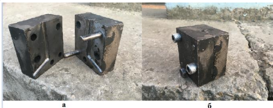
Рис. 1. а – матрица в разобранном виде; б – матрица в сборном виде
