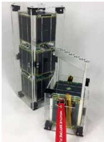
Рисунок 1 - Спутниковые платформы, собранные на базе конструктора «ОрбиКрафт-Про 1U» и конструктора «ОрбиКрафт-Про 3U»
