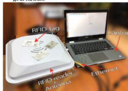
Рис. 1. Структура экспериментальной установки интеллектуальной RFID-системы
