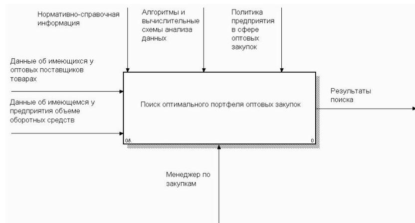
Рис. 6.1. Контекстная диаграмма процесса «Поиск оптимального портфеля оптовых закупок»
