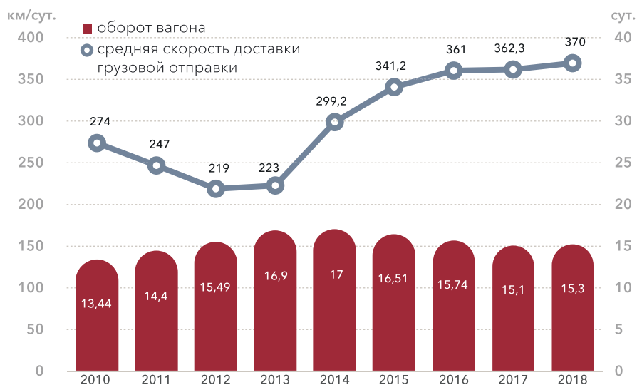
Рис. 1. Оборот вагона и средняя скорость доставки грузовой отправки на сети РЖД в 2010–2018 гг.
