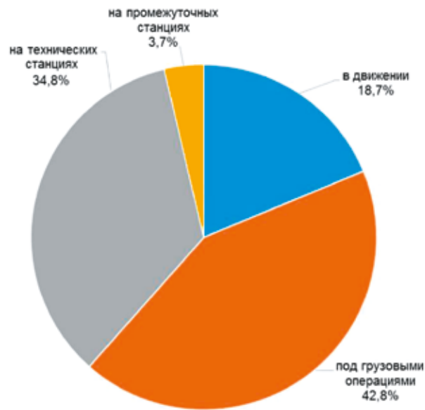
Рис. 4. Структура оборота вагона рабочего парка в 2018 г.
