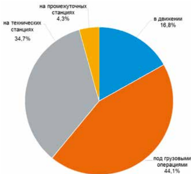
Рис. 3. Структура оборота вагона рабочего парка в 2011 г.
