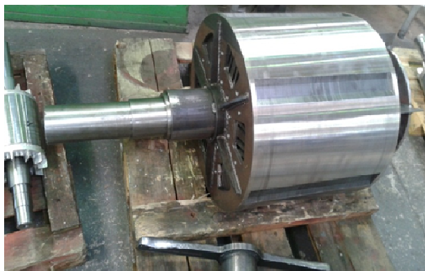
Рис. 4. Ротор реактивной электрической машины с анизотропной магнитной проводимостью ротора с поперечной шихтовкой
