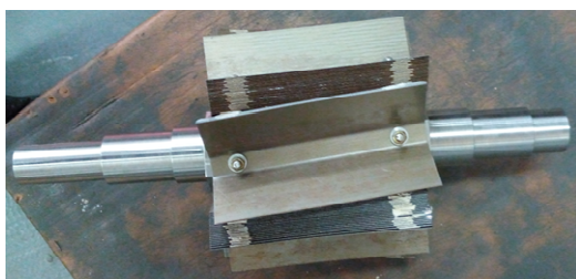
Рис. 2. Заготовка ротора реактивной электрической машины с анизотропной магнитной проводимостью со скосом полюсов ротора (до компаундирования и проточки)
