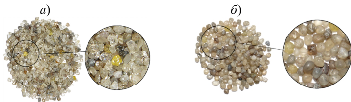
Рис. 2. Природные алмазы, используемые для оснащения буровых коронок: а – дробленные, б – овализованные
