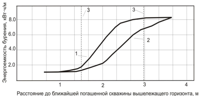
Рис. 2. Результаты исследования отбойки амфиболовых роговиков
